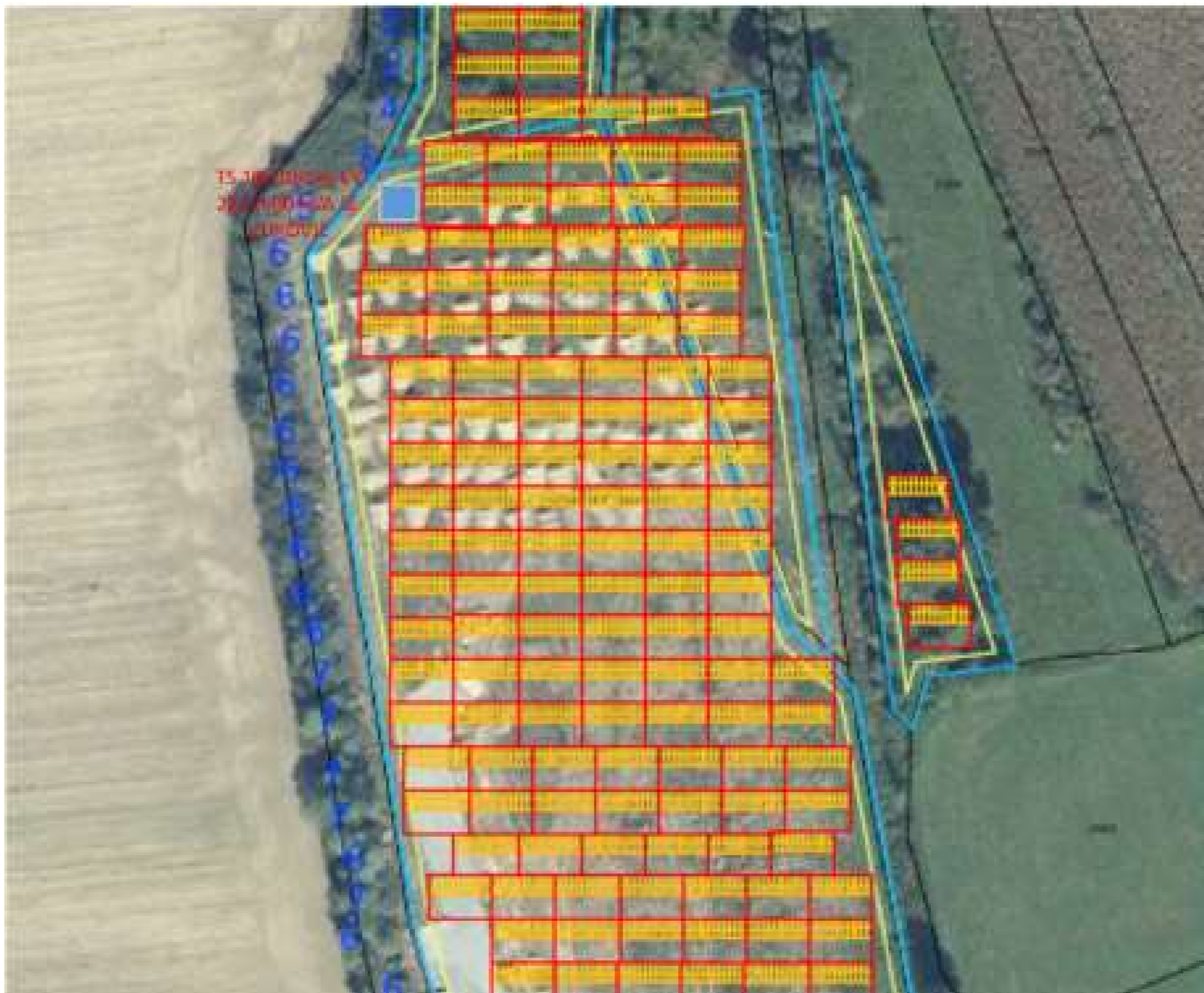
Slika 6. Lokacija TS 10(20)/0,8 kV 2x1250 kVA SE Vukovje (Izvor: Idejno rješenje, MEP INŽENJERING d.o.o., ožujak 2022.)
